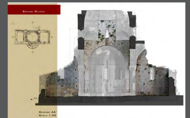
Sezione trasversale della chiesa di San Bruzio risultato della fase di rilievo e della post produzione.
