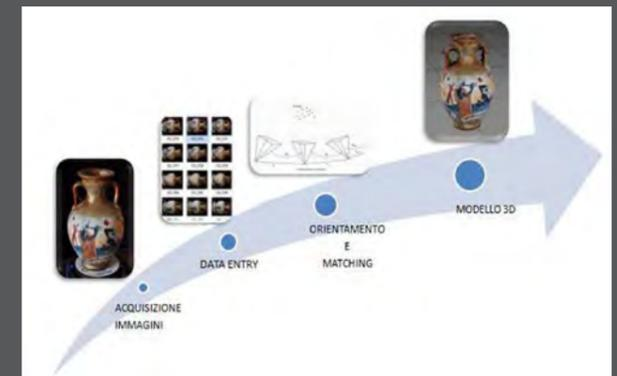
Workflow del processo di ricostruzione 3D del software 123D Catch
